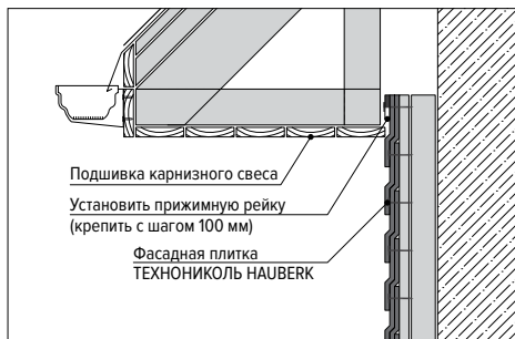
Рис. 9.1. Монтаж верхнего ряда под карнизным свесом
